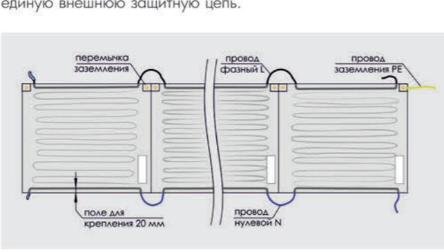
Поле ширины 20мм от бокового края нагревателя до фазного или нулевого провода предназначено для крепления нагревателя к потолочной поверхности.
