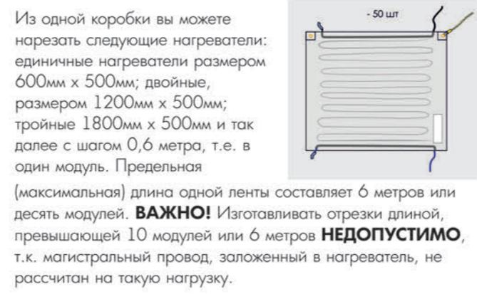
Из одной коробки вы можете нарезать следующие нагреватели: единичные нагреватели размером 600мм x 500мм; двойные, размером 1200мм x 500мм; тройные 1800мм x 500мм и так далее с шагом 0,6 метра, т.е. в один модуль. Предельная (максимальная) длина одной ленты составляет 6 метров или десять модулей. **ВАЖНО!** Изготавливать отрезки длиной, превышающей 10 модулей или 6 метров **НЕДОПУСТИМО**, т.к. магистральный провод, заложенный в нагреватель, не рассчитан на такую нагрузку.
