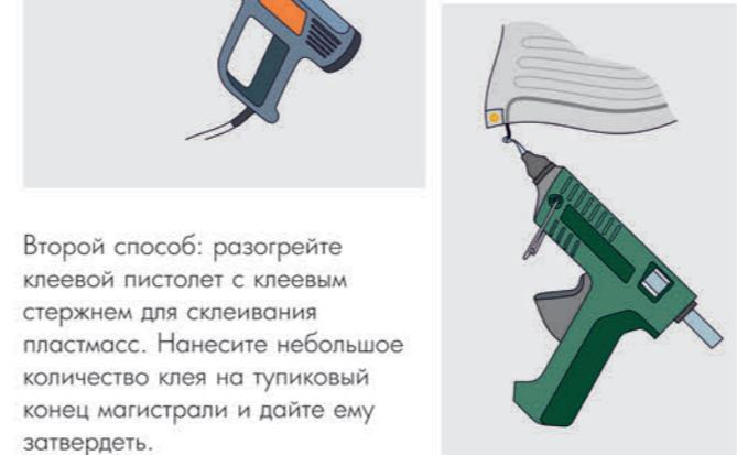
Второй способ: разогрейте клеевой пистолет с клеевым стержнем для склеивания пластика. Нанесите небольшое количество клея на тупиковый конец магистрали и дайте ему затвердеть.
