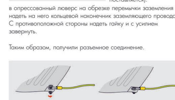
Вариант 2: Для болтового соединения необходимо вставить болт диаметром 4,0 мм (в комплекте не поставляется).
