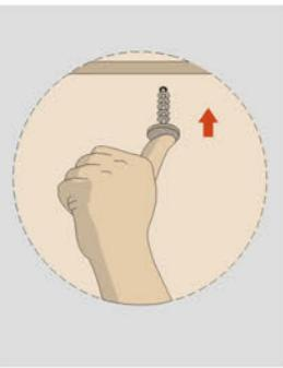
Следующий этап: поверх теплоизоляции, аналогично, крепим отрезки нагревателей. Для этого просверливаем сквозь поле крепления нагревателя отверстие буром 7,0 мм.
