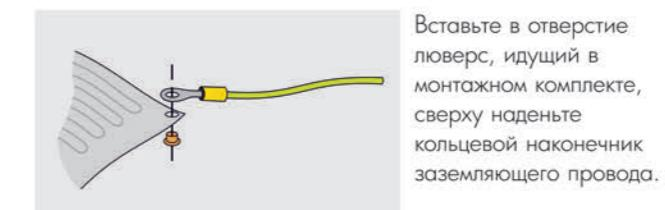
Вставьте в отверстие люверс, идущий в монтажном комплекте, сверху наденьте кольцевой наконечник заземляющего провода.
