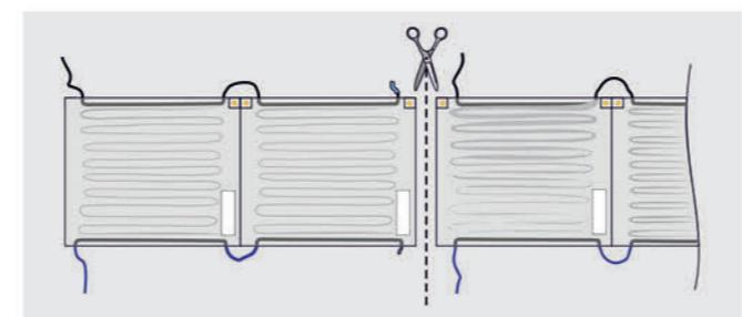
Изолирование тупикового конца магистрального провода может производиться двумя способами – при помощи ТУТ или при помощи клеевого пистолета.
