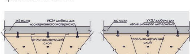
При помощи перфоратора, буром диаметром 7,0мм просверлите сквозь теплоизоляцию отверстие и при помощи большого пальца руки или основания ладони протолкните до упора УКЭ и прижмите теплоизоляцию к потолочной поверхности. **ВАЖНО!** Отверстие для УКЭ необходимо производить буром только диаметром 7,0мм.
