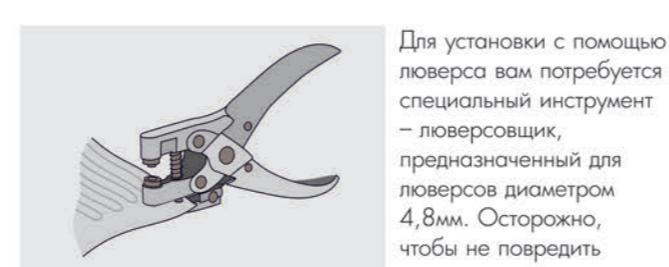
Для установки с помощью люверса вам потребуется специальный инструмент – люверсовщик, предназначенный для люверсов диаметром 4,8мм. Осторожно, чтобы не повредить
