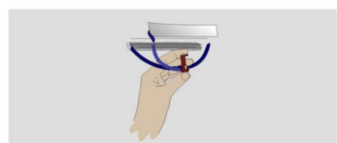
5. При помощи плоскогубцев полностью утаплите прокалывающую клемму ЗПО.
