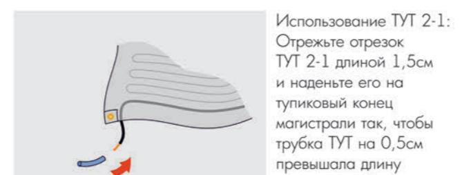
Использование ТУТ 2-1: Отрежьте отрезок ТУТ 2-1 длиной 1,5 см и наденьте его на тупиковый конец магистрали так, чтобы трубка ТУТ на 0,5 см превышала длину тупикового обрезка магистрали.
