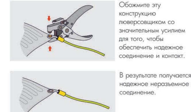
Обожмите эту конструкцию люверсовщиком со значительным усилием для того, чтобы обеспечить надежное соединение и контакт.
