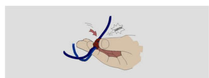
Коммутация этого соединения закончена. Аналогичную операцию нужно произвести с каждым проводом, соблюдая соответствие цветов проводов и выводов – все черные провода коммутируем с черной магистралью, синие с синей и желто-зеленые с желто-зеленой.
