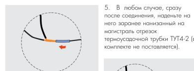
5. В любом случае, сразу после соединения, наденьте на него заранее нанесенный на магистраль отрезок термоусадочной трубы ТУТ4-2 [в комплекте не поставляется].
