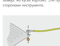
Вставьте в отверстие люверс, идущий в комплекте с нагревателями, сверху наденьте кольцевой наконечник заземляющего провода.
